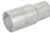
1/2" lang top med indvendig firkant og 14 mm indvendig sekskant 7805SM-14
