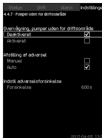
Fig. 112 Pumper uden for driftsområde
