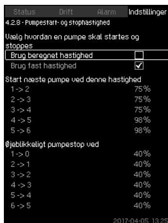
Fig. 64 Brug beregnet hastighed
