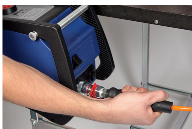
5.1 Tilslut den nippel del af det hydrauliske slage på bagsiden af pumpen
