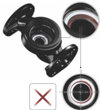
Fig. 9 Forkert centreret tætningssystem
