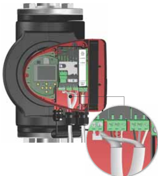
Fig. 43 Tilslutning af kabelskærm, klemmetilsluttede udførelser
