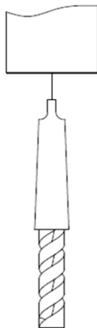
[billede 5.3 | Montering af boremaskine med MT3-skaft med MT3-MT2-adapter]
