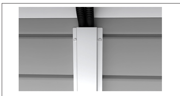
4. Monter med NM Wood Screw i alle huller.
