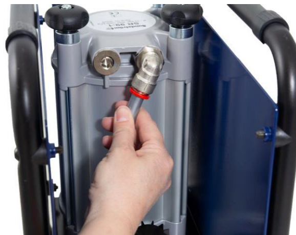
2.8 Tilslut slangen mellem regulatoren og filterlåget ved at trykke den røde muffe ind og føre slangen ind.
