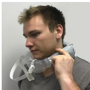
Малюнок 14. Пристрій зафіксований навколо шиї
