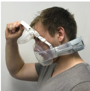
16. attēls – Iekares uzvilšana atpakaļ uz galvas
